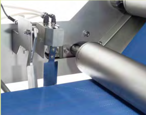
Vollautomatische Bandlaufsteuerung und Not-Aus bei Bandverlauf
