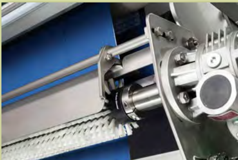
Leicht nachrüstbare, optionale Bürstenreinigung für die Entfernung von eingepressten Partikeln bei problematischen Presskuchen
