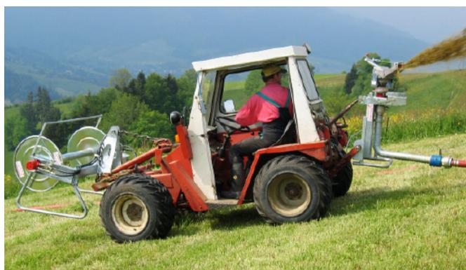
Enrouleur SH 800 avec entraînement hydraulique et attelage à 3-points
