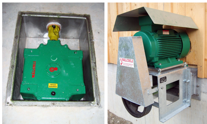
Exécution sous dalle avec entraînement de côté
