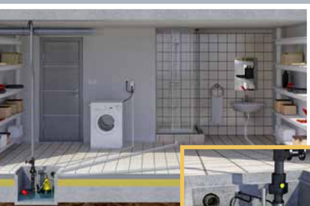
AG10 - Alarmgeber mit Kugeltauchschalter für Pumpenschächte
