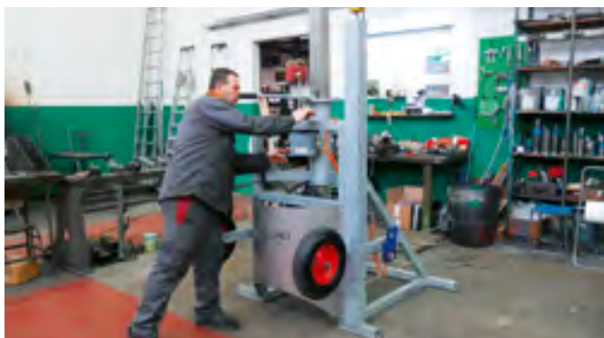
Vue de l'atelier de Brittnau: un brasseur à moteur plongeur est justement en révision.
