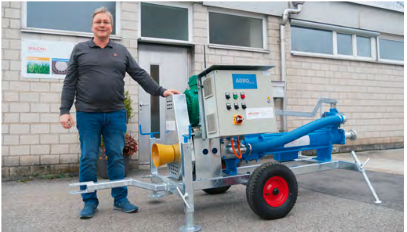
Beat Wälchli montre une de ses pompes à vis disponibles en plusieurs tailles et classes de performances. Photos: Heinz Röchlisberger et Idd
