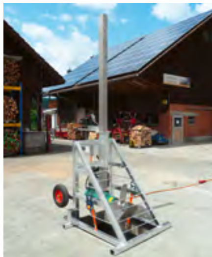
Un brasseur à moteur immergé est la solution idéale pour une utilisation dans plusieurs fosses à lisier.
